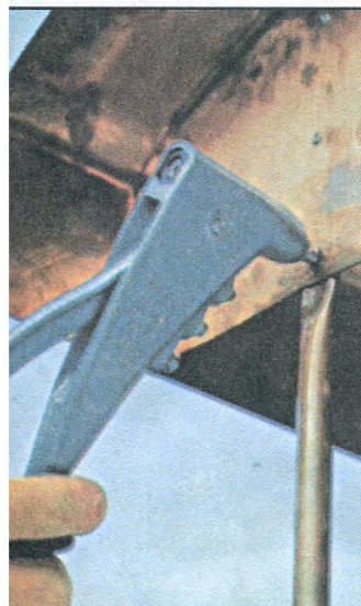
9 Боковины колпака камина выкраивают из медного листа ножницами по металлу, затем отгибают края и соединяют на заклепках с крышей и несущей штангой \varnothing 3/4" .
