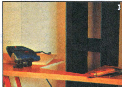
Выборку для этажерки сначала размечают, а затем вырезают лобзиком. Края распила шлифуют.
